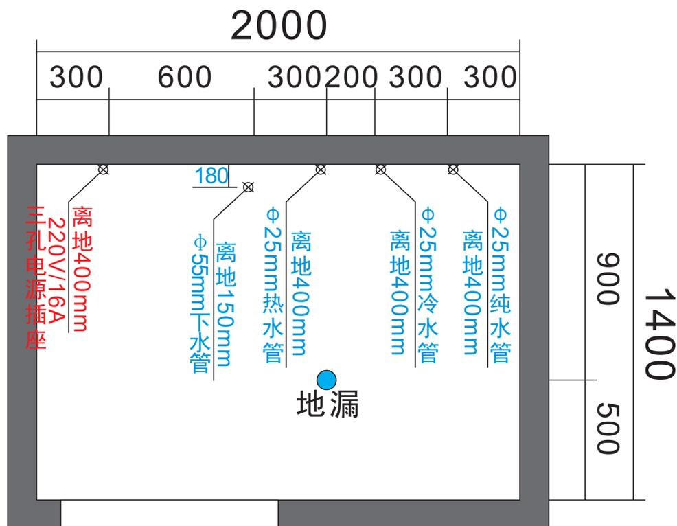
**注：为了更好的配合一体化内镜清洗消毒设备的安装和使用，建议贵院按此水电布局施工**
